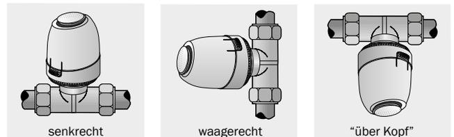
Der Stellantrieb ist bevorzugt in senkrechter und waagerechte Montagelage einzubauen. Bei "über Kopf"-Montage können spezielle Umstände (z.B. Schmutzwasser) die Lebensdauer reduzieren.
